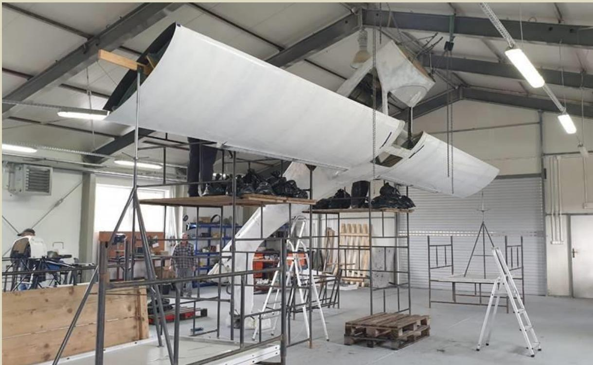
Als kleines Beispiel für den Aufwand soll das Bild oben dienen. Es handelt sich hier nur um einen Test der Landeklappen und des zugehörigen Antriebs – eigentlich eine Sache von etwa einer Stunde.
